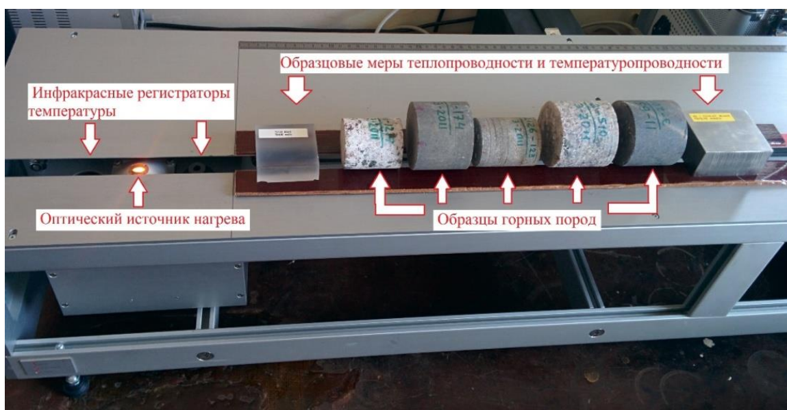
Рис.2 Установка оптического сканирования керновых образцов TCS
