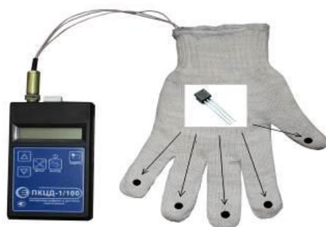
Рис. 2. Макет термометрической перчатки
