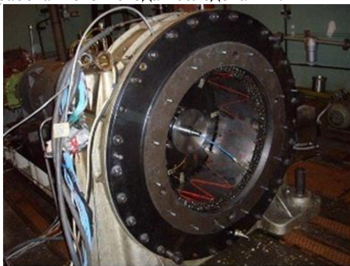
Рис. 1. Разгонный стенд с диском, установленным в вакуумной камере
