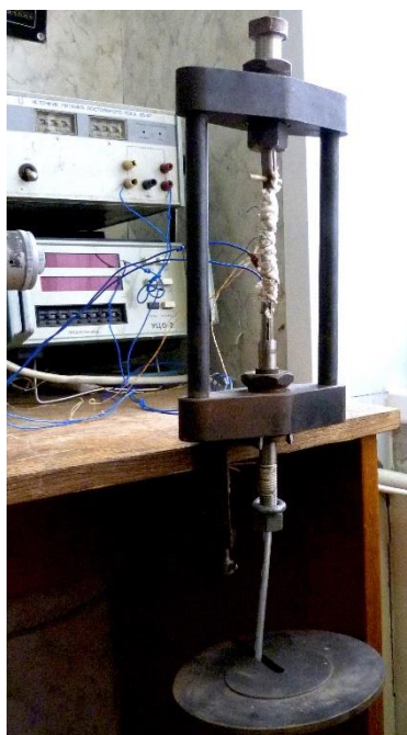
Рис. 5. Устройство для нагружения теплопроводника растягивающей нагрузкой
