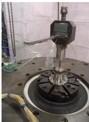
Рис. 7. Устройство для исследования температуропроводности материалов в поле действия виброускорений
