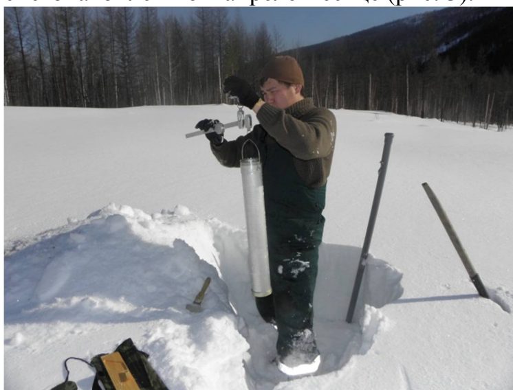
Рис. 3. Определение плотности снежного покрова
