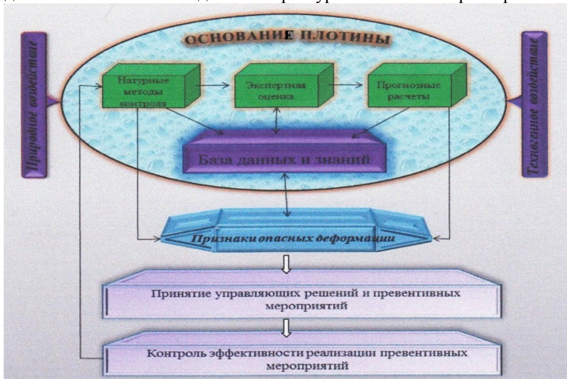
Рис. 1. Общая схема системы мониторинга основания плотины
