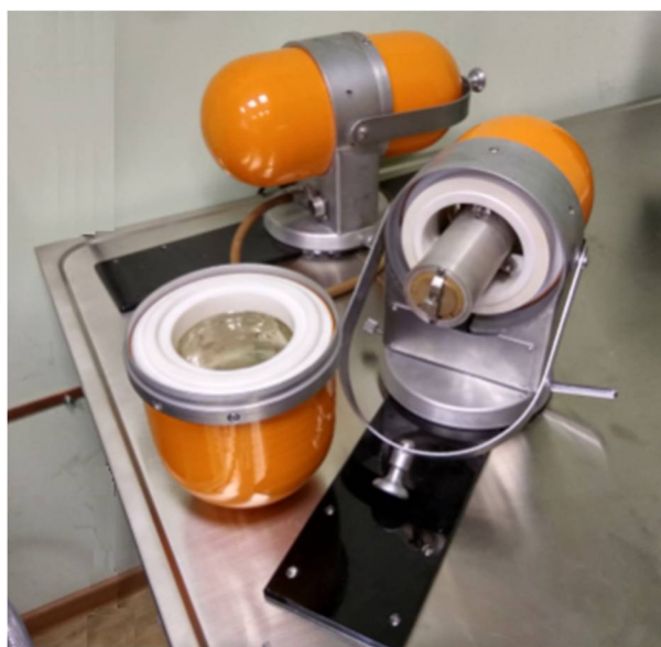
Рис. 2. Ячейки плавления установки «KRIAN» на основе сосуда Дьюара
