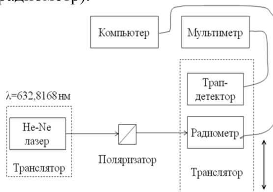
Рис. 2. Структурная схема радиометрического комплекса для воспроизведения сверхвысокой термодинамической температуры
