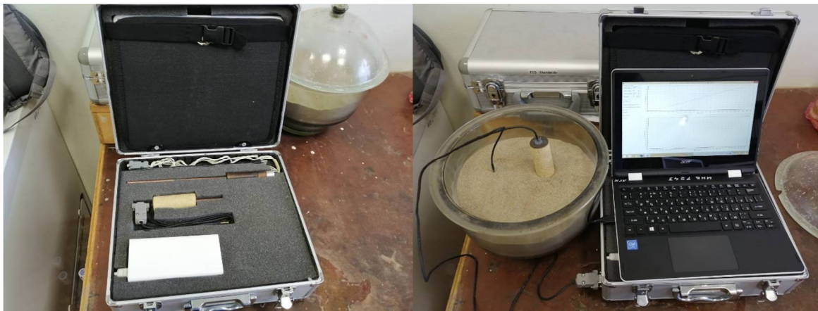
Рис. 3. Схема конструкции программно-аппаратного комплекса для полевого определения теплопроводности грунтов методами цилиндрического зонда постоянной мощности
